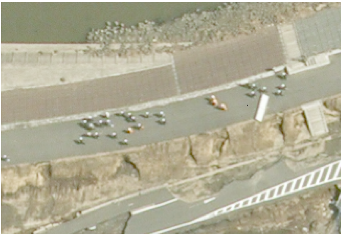
Fig.13.1 GSD が 16.5cm の空中写真で人間を上から見た例 「認識」レベルには少し画素が足りないが、この例では、道路上で、同じ程度の長さで影があり、服の色が異なるが頭部は白いヘルメットであることから、人間と認識できる。
