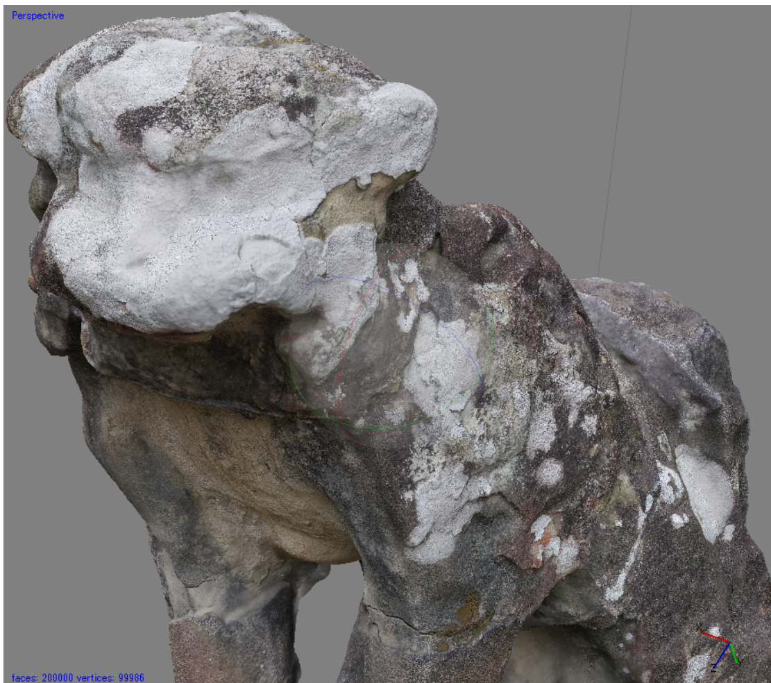
Fig.8.2 Build Texture 処理の結果。Mapping mode: Generic, Blending mode: Mosaic, Fill holes: Checked, Atlas width/height: 4096。Atlas width/height は 4096 で十分に解像感の高いテクスチャーが得られる。
