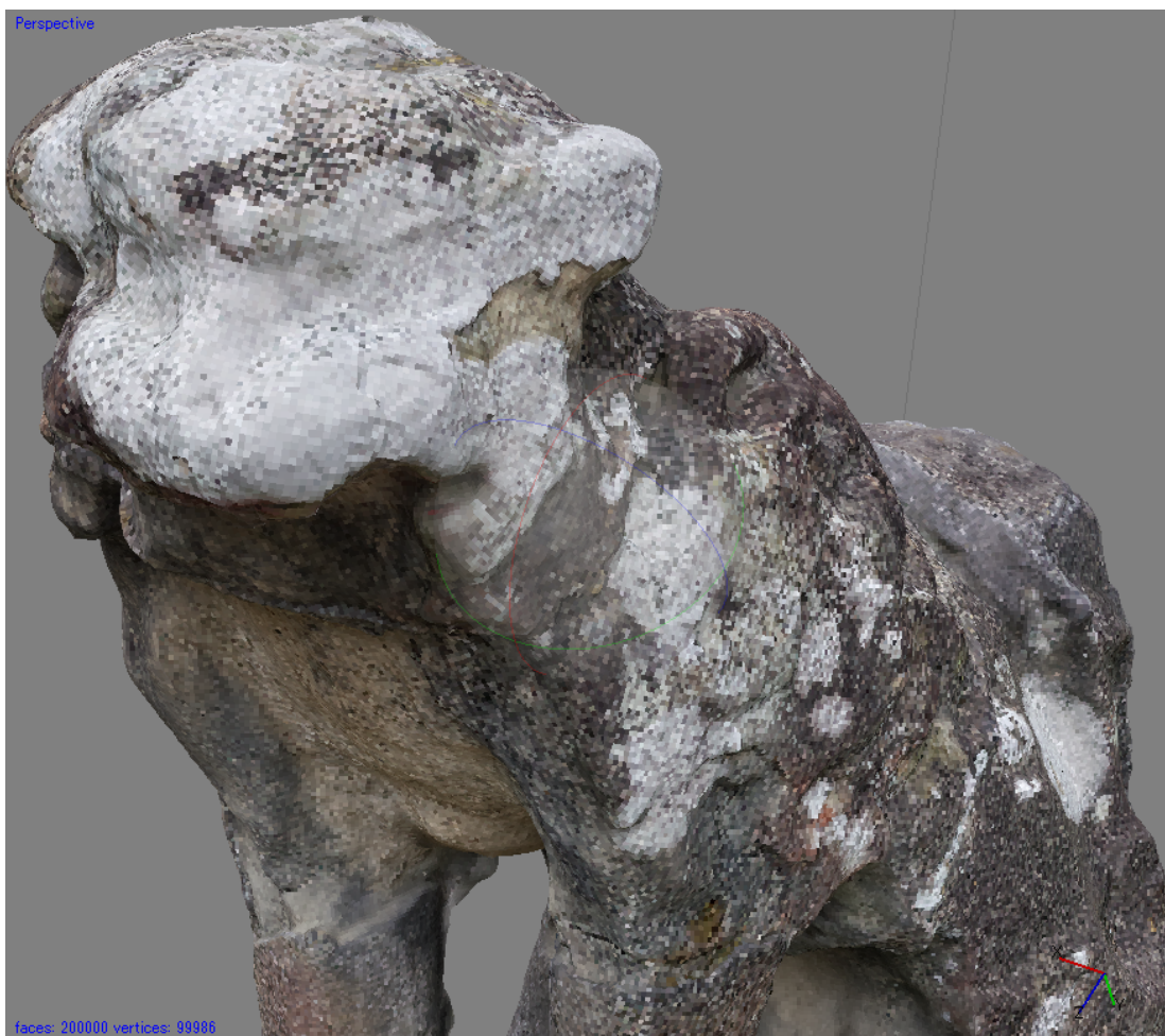
Fig.8.3 Build Texture 処理の結果。Mapping mode: Generic, Blending mode: Mosaic, Fill holes: Checked, Atlas width/height: 1024。Atlas width/height を 1024 まで下げると、かなり粗いテクスチャーになる。ただし、表示は高速になるため、速度の遅いノート PC 等で使用する場合は、3D PDF にエクスポートしてメールで添付する場合などには有用な設定となる。
