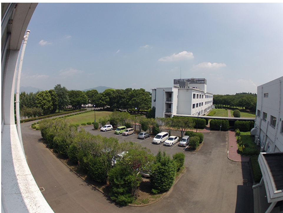
Fig.2.5 広角過ぎる画像の NG 例：画角 170 度の超広角レンズにより、画像周辺が激しく変形している (GoPro2 画像)
