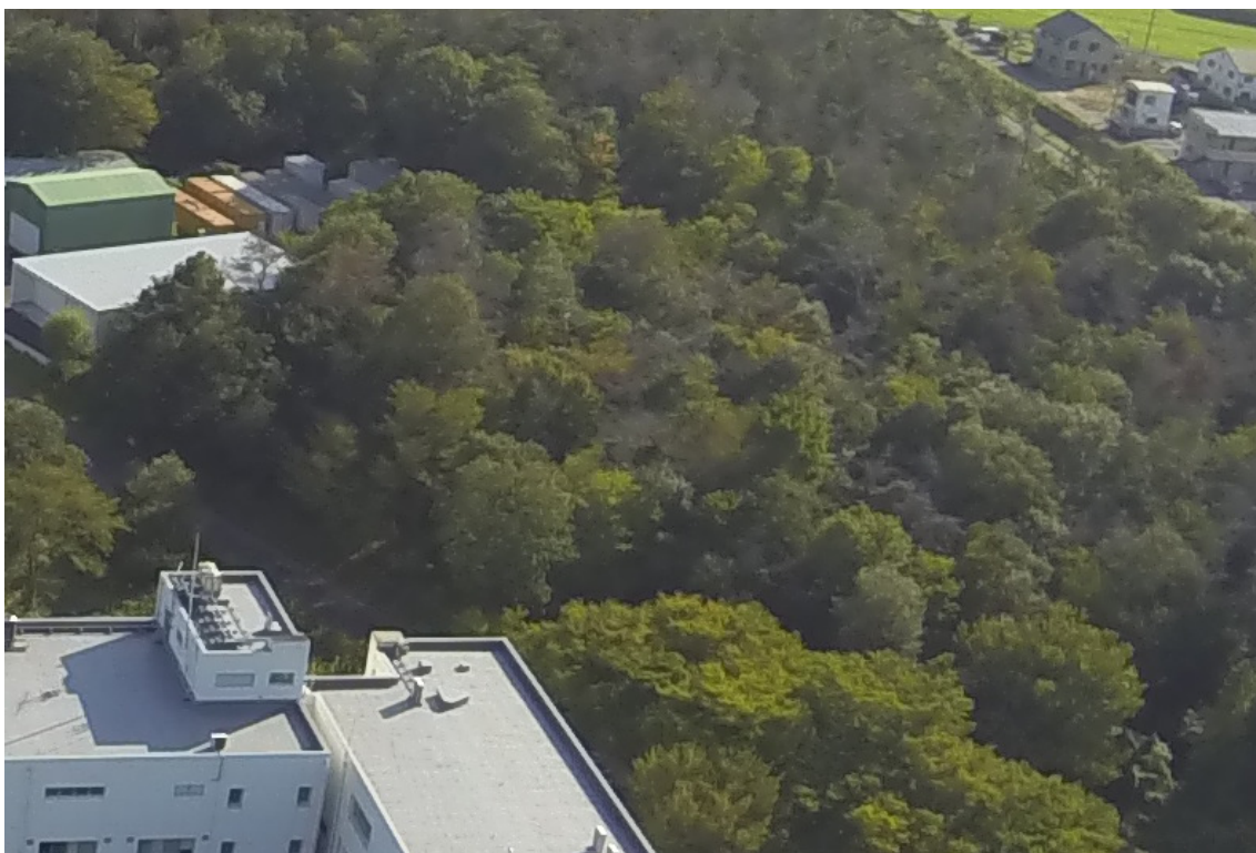
Fig.2.3 カメラ側の画像処理エンジンで行われる不要な画像処理の NG 例。樹林のテクスチャがべた塗りの水彩画のようになっている (GoPro3 画像の等倍表示)。輪郭補正、超解像処理、様々な機能が提供されているが、写真測量には一切不要。全部オフにする。
